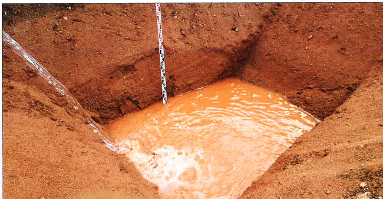
Abbildung 1: Sickerversuch im angelegten Baggerschurf in Massenricht am 02.11.2020
